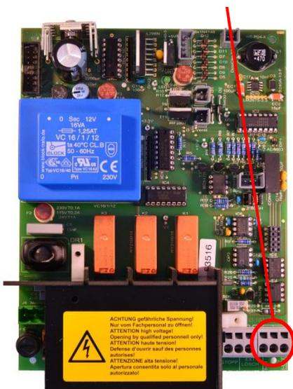
Über den Ausgang der Stromschnittstelle (I-OUT (+) / I-IN (-)) können die Ergebnisse der Analysen bzw. Zustände registriert werden. Dazu werden die folgenden definierten Werte für Status- und Fehlermeldungen ausgegeben:
