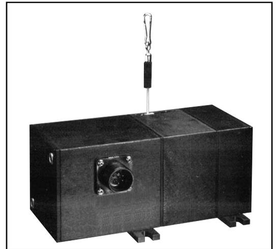
Avec un potentiomètre à piste hybride comme élément de mesure, le PT5A offre de multiples options: différentes étendues de mesure de 254 à 6350mm, une sélection de potentiomètres de 500  $\Omega$  à 10 k $\Omega$  ou une sortie pont ajustable, 4 orientations de sortie de câble et 3 types de connexions électriques.
